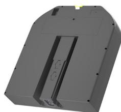
Batterie 24V / 40Ah avec système de chauffe intégrée, système de mise en place guidée et sécurisée, caisson 70% fibre de verre et 30% ABS (ultra-robuste)
