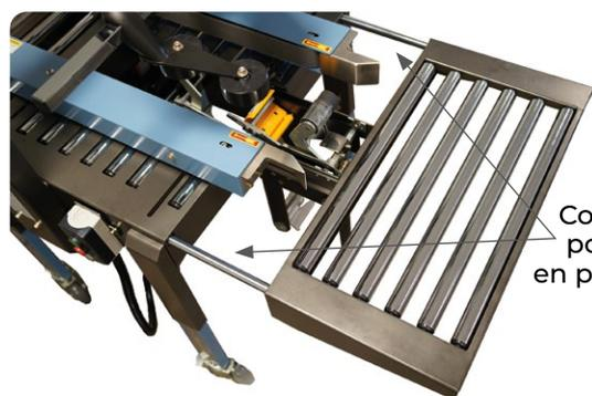
Conveyor extensible pour faciliter la mise en place du bloc couteau et de l'adhésif
